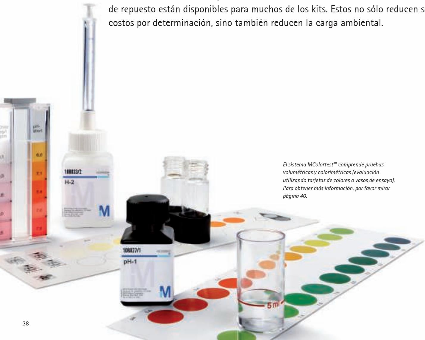
*El sistema MColortest™ comprende pruebas volumétricas y colorimétricas (evaluación utilizando tarjetas de colores o vasos de ensayo). Para obtener más información, por favor mirar página 40.*
