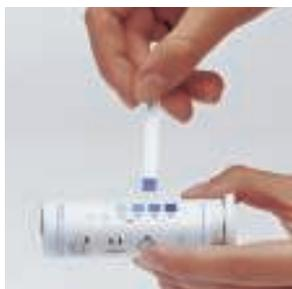
Después que el tiempo de reacción especificado, de máximo un minuto, haya expirado, el color de la zona de reacción se compara con la escala en color impresa en la etiqueta del envase y la concentración correspondiente puede leerse con facilidad.
