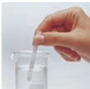
Las zonas de reacción se impregnan con la solución que se va a analizar simplemente sumergiéndolas brevemente en la muestra líquida. Cualquier líquido excedente se elimina sacudiendo o pasando la varilla de ensayo por el borde del recipiente.
