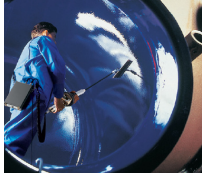
Detección de poros en el esmaltado de un reactor con POROSCOPE®
