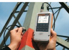
Medición dúplex (pintura/Zn) en estructuras
