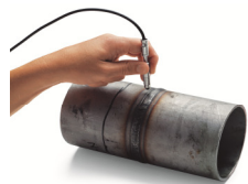
Ensayo en un cordón de soldadura con la sonda FGAB1.3-Fe
