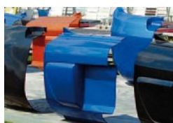
Test de intemperie para evidenciar las influencias en la pintura. Atlas Material Testing GmbH
