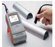
Medición empleando una sonda FTD3.3 con corrección para curvatura
