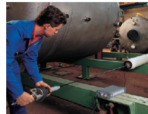
Ensayo en el interior de conducto con electrodo rotativo adaptado al POROSCOPE®
