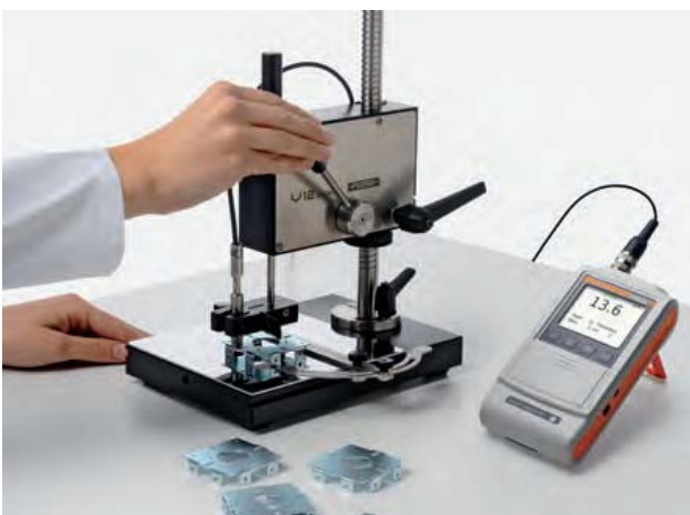
Medición empleando un equipo DUALSCOPE® FMP40 con una sonda FGAB1.3 alojada en el soporte de la mesa V12
