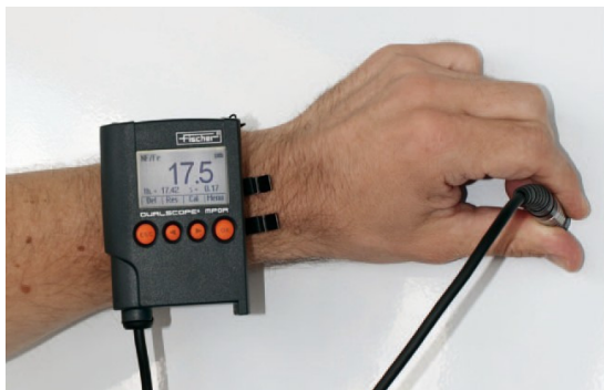
Accesorio de muñeca para la medición con una sola mano para los instrumentos MPOR-FP
