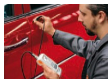
Medición del espesor de pintura en carrocerías
