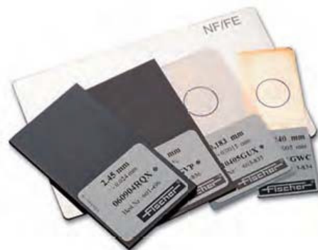
Láminas patrón de espesor certificado. Con posibilidad de calibración DKD/ENAC bajo petición
